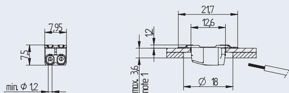
Anmerkung / note 1: Die maximale Paketdicke von Platine und Kühlkörper sollte 3.6 mm nicht überschreiten.
