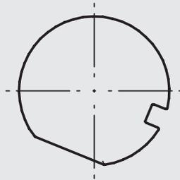
**Elektromechanische Schnittstelle für Außenleuchten nach ZZ Zhaga Book 18 zur Aufnahme von Kommunikations- und Sensoreinheiten**
