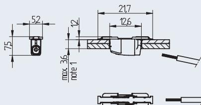
Anmerkung / note 1: Die maximale Paketdicke von Platine und Leuchtgehäuse sollte 3.6 mm nicht überschreiten.
