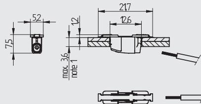
Anmerkung / note 1: Die maximale Paktetdicke von Platine und Leuchtgehäuse sollte 3.6 mm nicht überschreiten.
