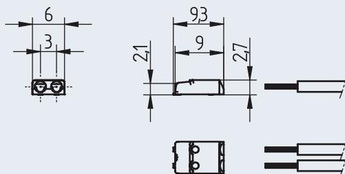
Generelle Empfehlung: Die beiden Lötflächen eines Klemmpoles auf der Platine sollten elektrisch miteinander verbunden werden
