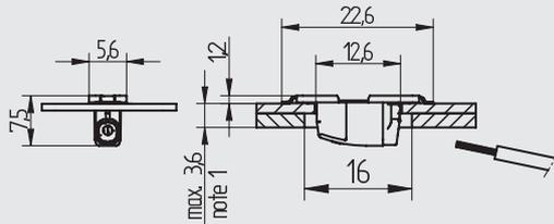
Anmerkung /note 1: Die maximale Paketdicke von Platine und Kühlkörper sollte 3.6 mm nicht überschreiten.
